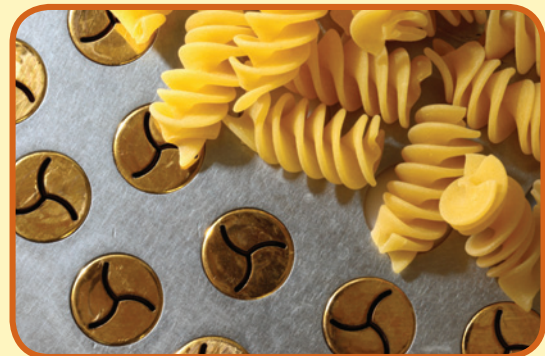
As extrusoras de massas criam diferentes formas.
